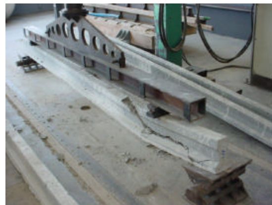
Flexió d'una bigueta de formigó
