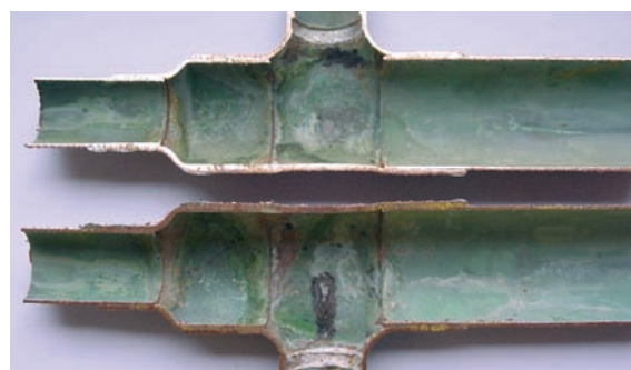
Mostra de tub de coure per a l'anàlisi de deficiències en la soldadura.
