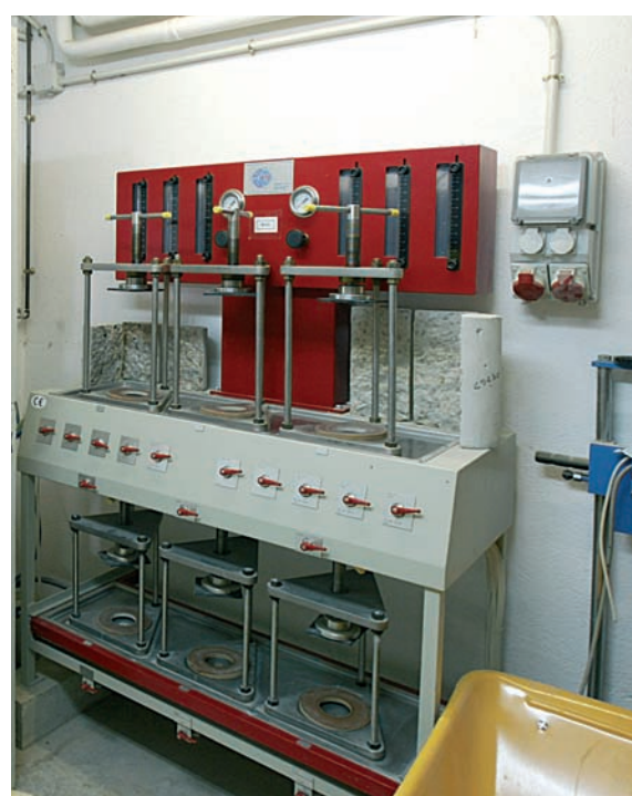
Permeabilitmetre per a la determinació de la profunditat de penetració d'aigua sota pressió.
