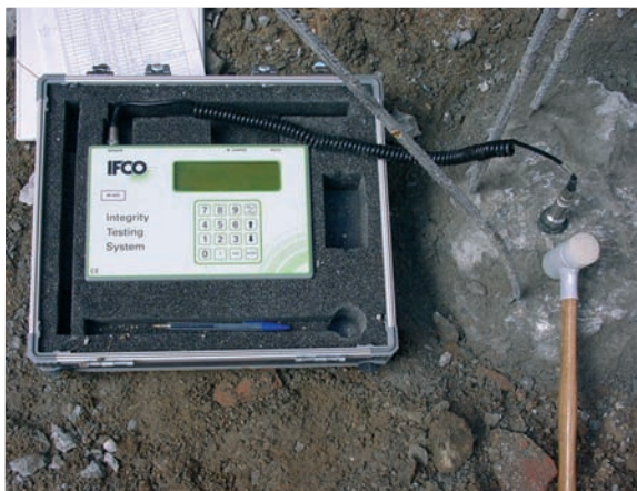
Equip per a l'assaig sònic d'integritat de pilons.
