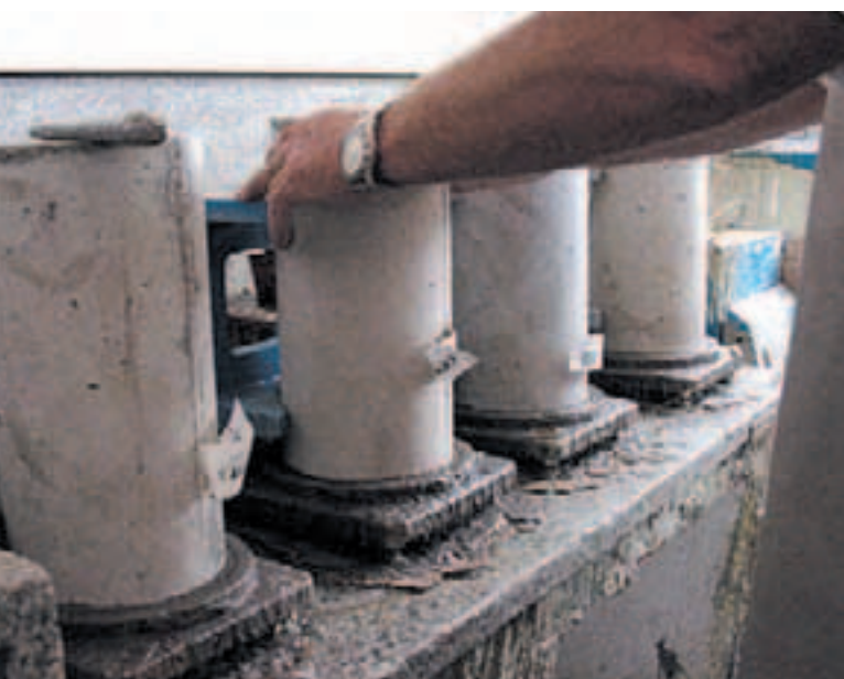
Operari "recapçant" provetes de formigó cilíndriques al laboratori, pas previ, a l'assaig a compressió
