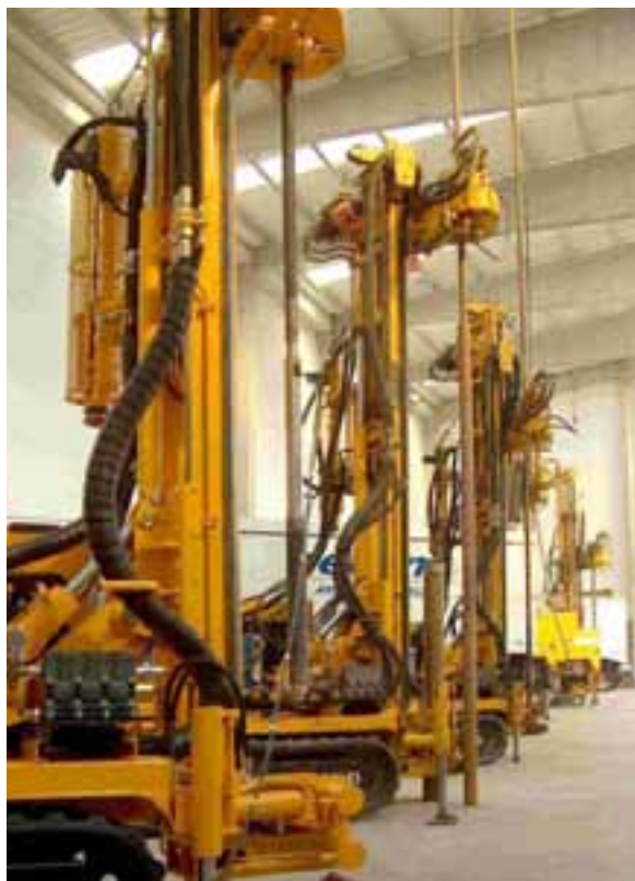
Perforadores a rotació amb bateria, per extracció de testimoni continu.
