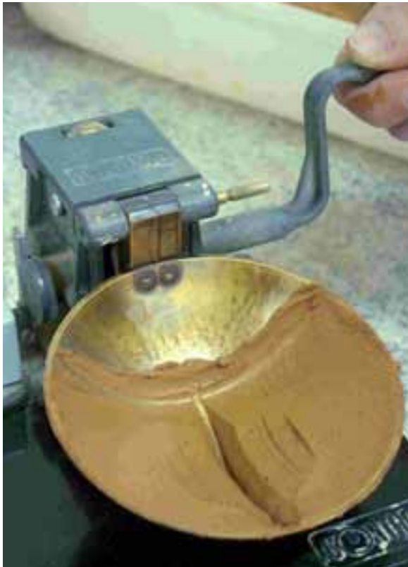
Cullera de Casagrande, per determinar la plasticitat de les terres.
