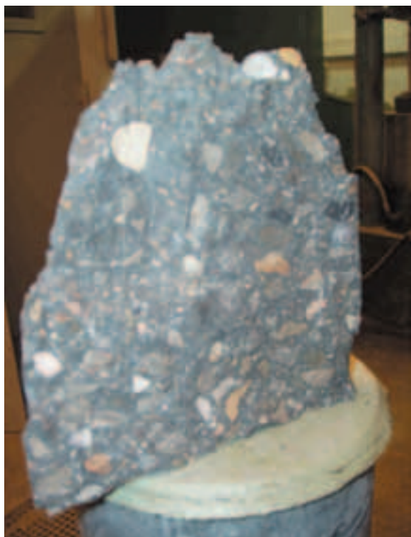
Fotografia núm. 2: Trencament en una proveta de formigó d'alta resistència on es pot observar la "planeïtat" de la superfície de fractura amb el trencament dels àrids com a part dèbil del conglomerat.
