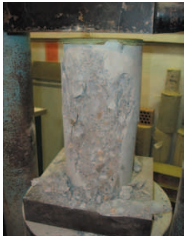
Fotografia núm.1: Trencament en una proveta de formigó convencional on es pot observar el fenomen "d'engranament" dels àrids al voltant de la superfície de fractura.
