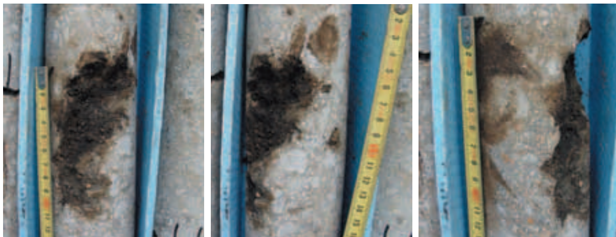
Fotografies 4, 5 i 6: Detall de la magnitud del defecte a la zona central del testimoni des de diferents angles.
