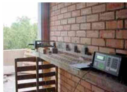
ADHERÈNCIES D'APLACAT DE FAÇANA.
