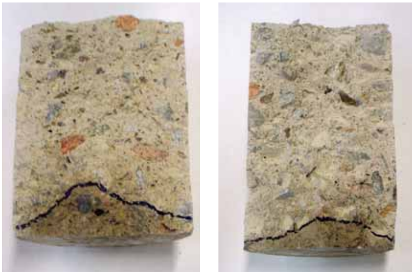
PROVETES SOTMESES A L'ASSAIG DE PENETRACIÓ D'AIGUA
