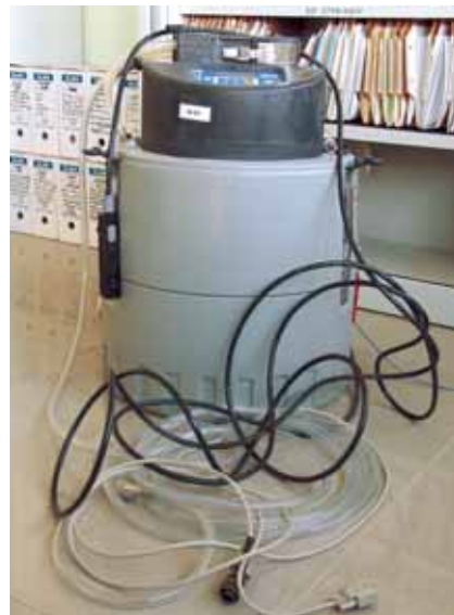
MOSTREJADOR PORTÀTIL AMB MÒDUL DE CABAL I SONDA DE CONDUCTIVITAT/TEMPERATURA.
