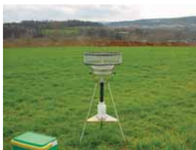
CONTROL DE POLS. CAPTACIÓ DE PARTÍCULES SEDIMENTABLES EN UNA ACTIVITAT EXTRACTIVA
